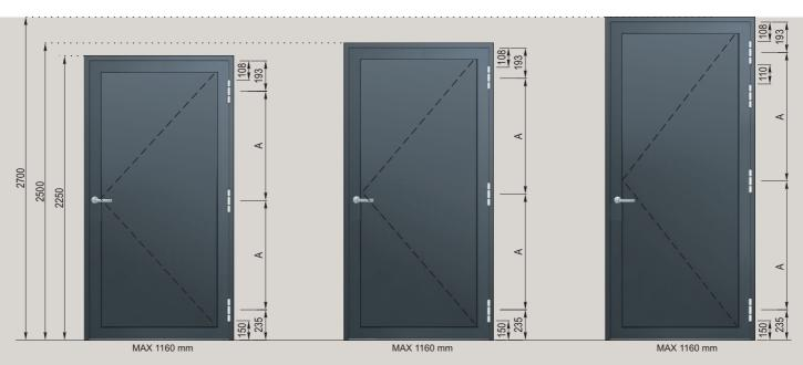
Rollenband für Anschlagtüren nach innen öffnend Türflügel mit innerem Aufschlag
