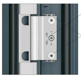
Seitliche Verstellung max. 2 mm Exzenter mit Schrauben dreher ISR25 drehen.
