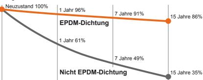
\* Verhalten einer Dichtung bei wiederkehrendem Zusammendrücken (Öffnen-Schließen des Fensters).
